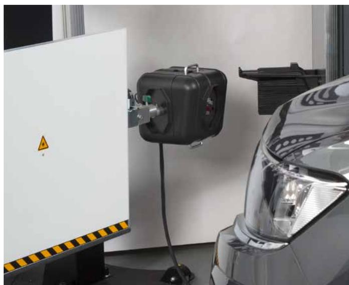
Камера для подготовки калибровки систем вспомогательных функций водителя - VAS 701 001/1. Простая установка на VAS 6430.
